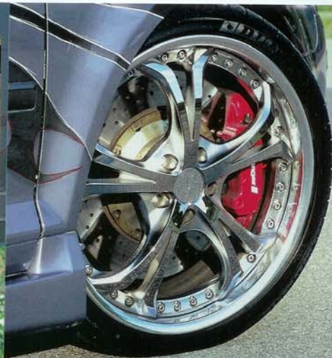
19" Leon Hardiritt-Rad mit versenkten Schrauben und einem verchromten Stern
