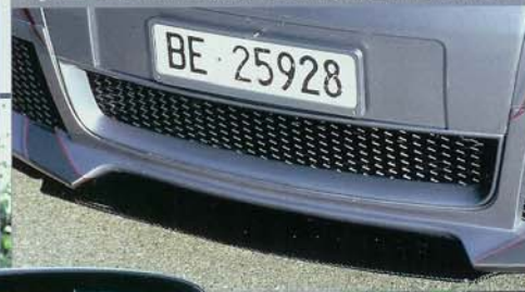
Vergitterter Lufteinlass mit kompletter Umrahmung; Spoiler mit Carbon-Schwert
